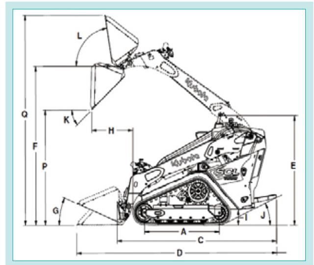
Fig. 5 Loader Dimensions
