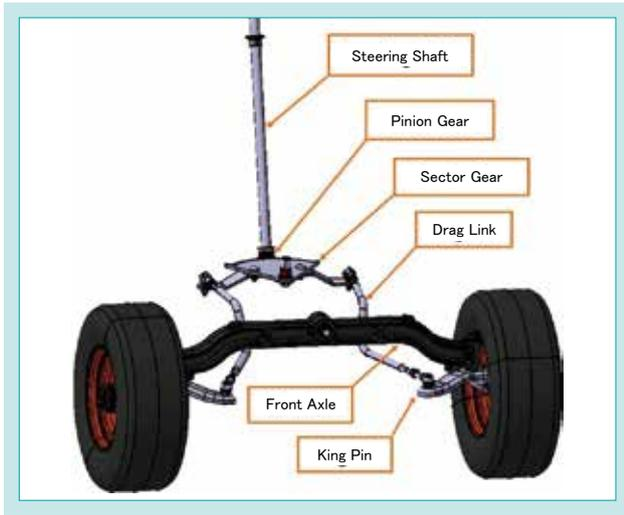
Fig. 8 T90-Series Steering System
