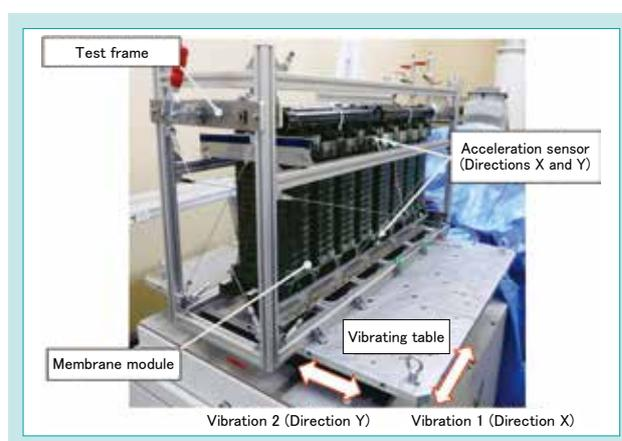
Fig. 9 Vibration Test
