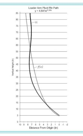
Fig. 4 Pivot Pin Path
