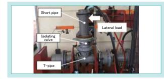
Fig.  $8\,\mathrm{Aspect}$  of Lateral Load Test
