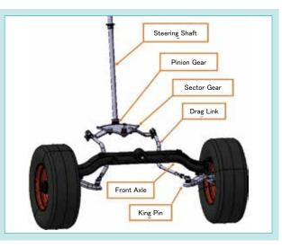
Fig. 8 T90-Series Steering System
